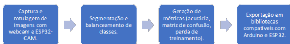
FIGURA 1 - Fluxograma de desenvolvimento de um identificador de imagem pelo Edge Impulse .
