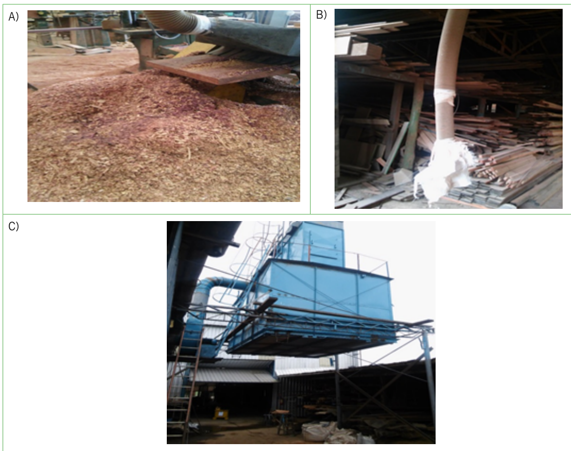
Figura 4 – Processo de produção do resíduo de maravalha (a) maravalha (b) sugador da maravalha (c) setor de armazenamento da maravalha.
